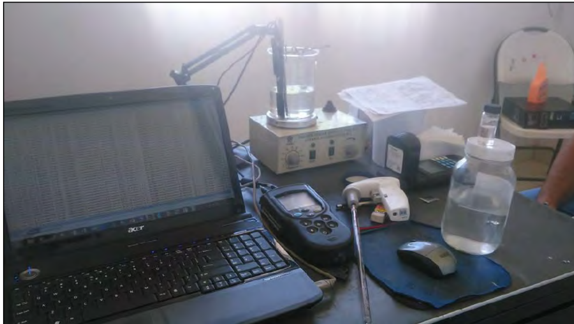
Figura 9 Estudio de la conductividad eléctrica durante el proceso de decationización
